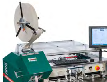
PräziSpine C1 Zuschneiden von flexiblen Rückeneinlagen von Schrenzrollen
