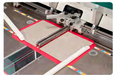
PräziCase Pro C1 Abschneiden der Ecken, Einschlagen aller 4 Kanten, Umlegen der Eckenfalte und Anpressen der Gesamtfläche
